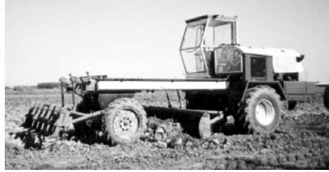
Sl. 13. Prikaz izvedenog rešenja u radu samohodne mašine za uređenje zemljišta, USM-5
