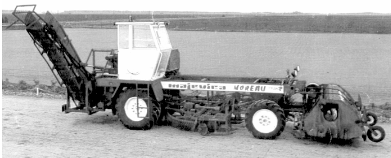
Sl. 11. Kombajn za vađenje šećerne repe "Majeвица" - "Moreau" na samohodnom nosaču oruđa
