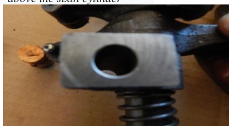
Slika 9. Oštećena treća površina nosača klackalica koja dodiruje glavu iznad šestog cilindra, motora proizvođače Caterpillar 3126
