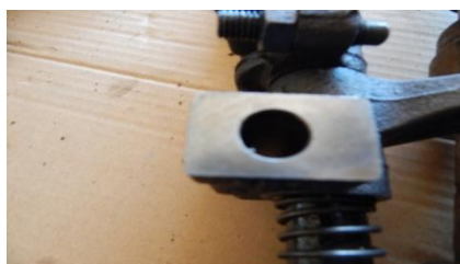
Slika 11. Neoštećena druga površinu nosača klackalica koja dodiruje glavu iznad šestog cilindra, motora Caterpillar 3126 - radi upoređenja sa oštećenom površinom
