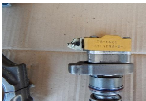
Slika 23. Brizgač - injektor šestog cilindra motora drobilice za drvo
