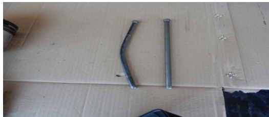
Slika 19. Deformisana i nedeformisana šipka podizača izduvnog ventila na šestom cilindru motora
