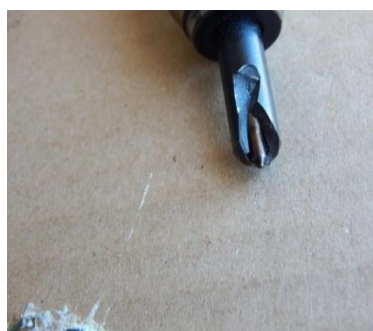
Slika 24. Oštećen brizgač - injektor šestog cilindra motora drobilice za drvo
