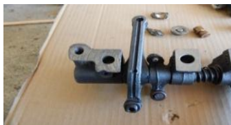
Slika 7. Oštećene površine nosača klackalica koje dodiruju glavu iznad šestog cilindra motora Caterpillar
