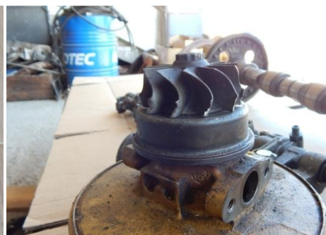
Slika 22. Oštećene lopatice turbine motora drobilice za drvo
