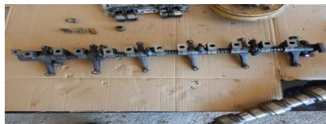
Slika 8. Površine nosača klackalica koje dodiruju glavu motora proizvođače Caterpillar
