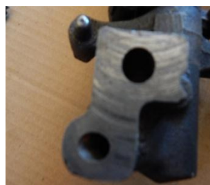
Slika 10. Oštećena treća površinu nosača klackalica koja dodiruje glavu iznad šestog cilindra motora
