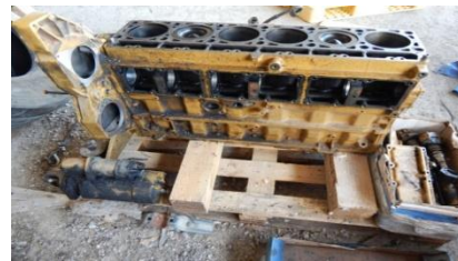
Slika 4. Blok pogonskog motora proizvodnje Caterpillar tip 3126 - pogled sa boka Figure 4. Caterpillar production engine block - side view
