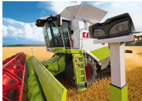
Slika 15. Izgled i položaj laserskog sistema Laser pilot na kombajnu Lexion 580
