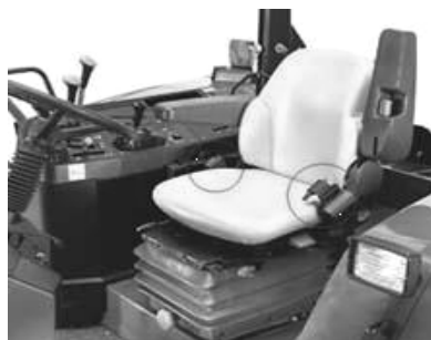
Sl. 5, 6. Sigurnosni kaiševi za vezivanje rukovaoca za osnovi sedišta traktora [25]
