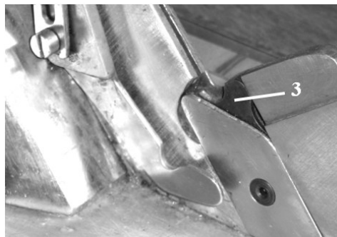
Слика 6. Обликач за формирање коначног – завојног облика клипсе
