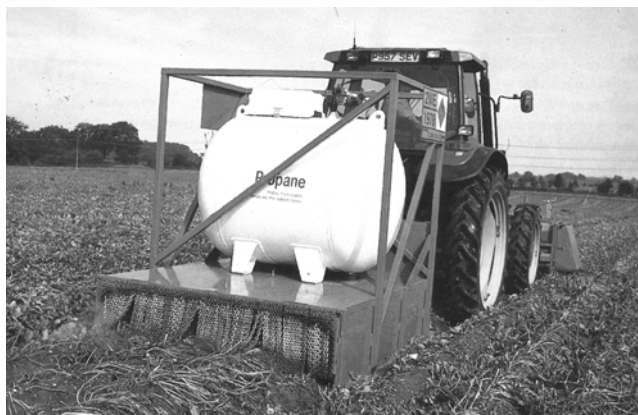
Sl. 4 Uništavanje lisne mase sitnilicom i termičkim sušenjem
