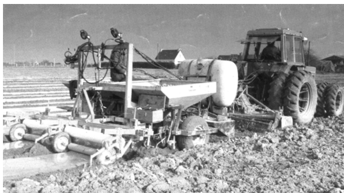
Sl. 2. Priprema zemljišta, sadnja i malčovanje zemljišta folijom
