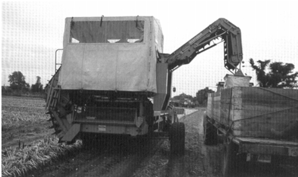
Sl. 6. Istovarni transporter sa uređajem za ublažavanje pada krtola
