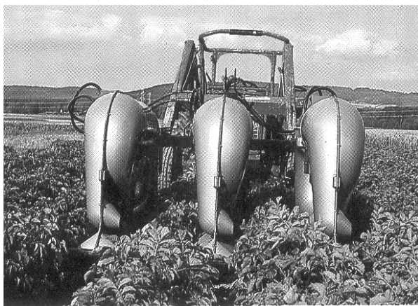
Sl. 3. Mašina za sakupljanje krompirove zlatice i njenih larvi
