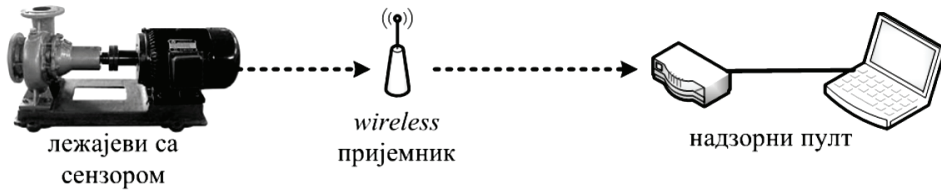
Сл. 3. Шематски приказ надзора температуре кугличних лежајева помоћу бежичне (wireless) везе између склопа са сензором и надзорног пулта управљања
