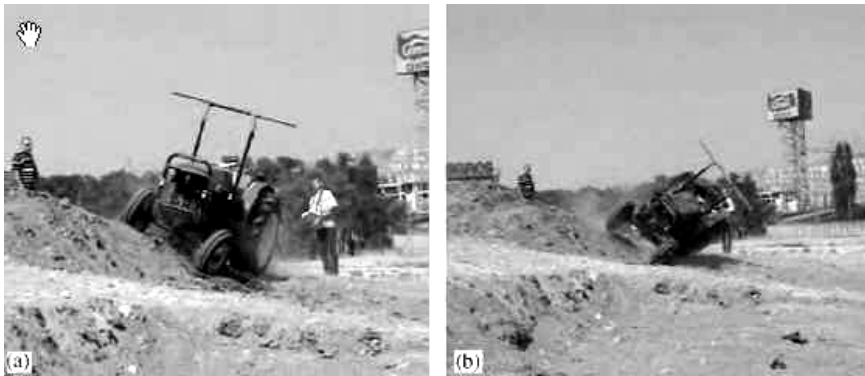
Sl. 6. Ispitivanje zaštitnog rama u uslovima prevrtanja traktora (NIOSH, USA), [24]
