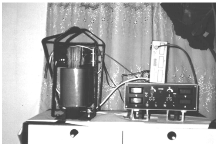
Sl. 3. Elektromagnet MOV-2 i kontrolni instrument KU-1-MOV
