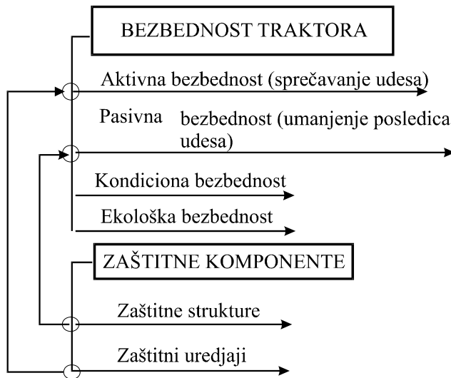
Sl. 2. Uz definiciju - bezbednost traktora i zaštitne komponente Fig. 2. To definition of tractor safety and protection components
