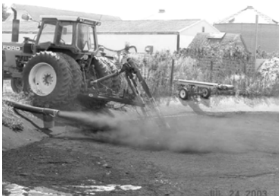
Sl. 5. Primena gumeno-poroznog pokrivača na površini lagune tečnog stajnjaka (probni položaj u Ajovi)- levo i University Olfactometer Laboratory- desno
