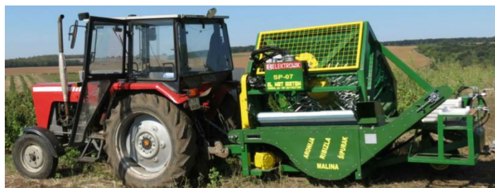
Slika 2. Vučeni berač jagodastog voća „ELEKTRONIK“ SP-07. Izvor: [4] Figure 2. Trailed Berry Fruit Harvester „ELEKTRONIK“ SP-07. Sources:[4]
