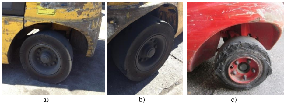
Slika 1. Primeri mehaničkih oštećenja na točkovima viljuškara (sopstveni izvor) Figure 1. Examples of mechanical damage on forklift wheels (own source)
