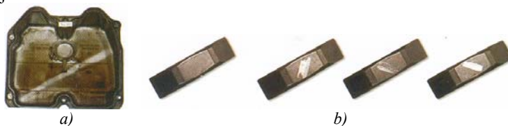
Slika 6. Spoljašnji izgled poklopca (a) i klackalica (b) nakon primene različitih kvaliteta ulja
