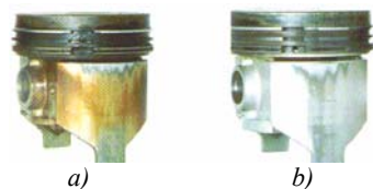
Slika 5. Spoljašnji izgled klipa primenom niskokvalitetnog (a) i visokokvalitetnog (b) ulja
