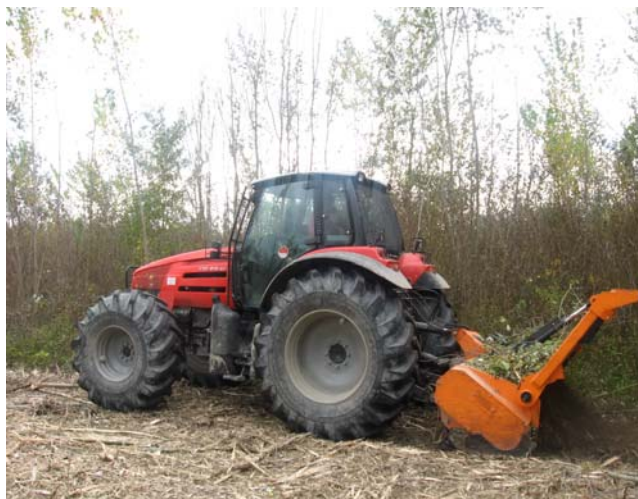
Slika 6. Uklanjanje žbunaste vegetacije traktorom Same Iron 210 DCR sa mulčecom LIPA –AHWI 600
