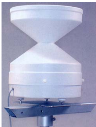
Sl. 1. Merač visine vodenog taloga (kišomer)
