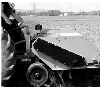
Sl. 1. Međuredna freza sa pogonom od traktorskog priključnog vratila
