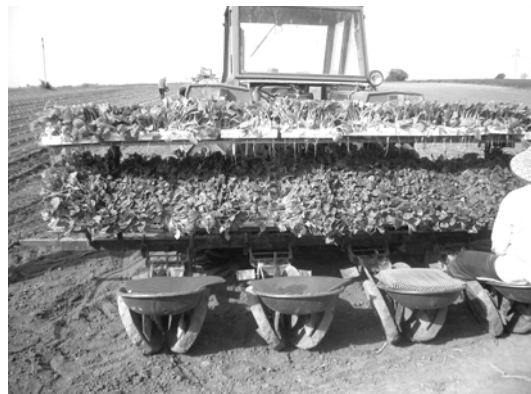
Sl. 3 Transport kontejnera sa rasadom na sadilici
