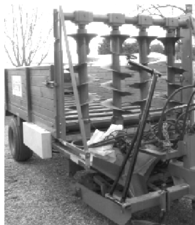
Слика 6. Садилуца за мискантус „Hvidsted Energy“
