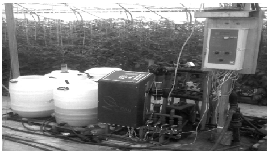
Sl. 18. Kontrolna jedinica FX 200 (model IZ2V30) sa mikser mašinom, ventilima i senzorima, Zeleni hit 2007.
