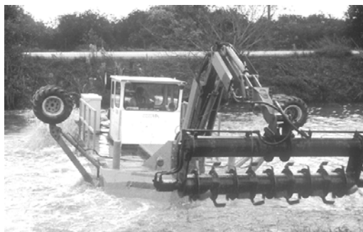
Сл. 4. Машина за култивирање дна аквасистема
