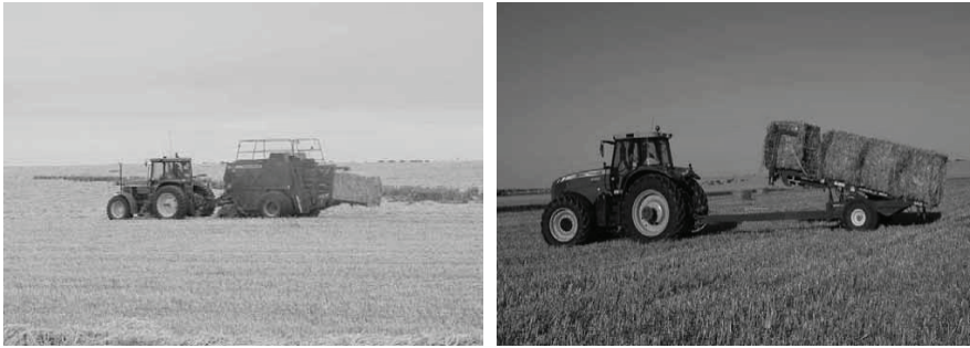
Sl. 2. Konfiguracije poljoprivrednog traktora, a/ radna, b/ transportna.
