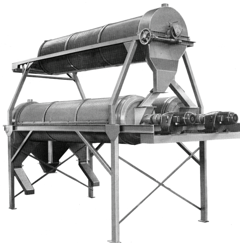
Sl. 1. Trijer sa tri cilindra tipa Hotyp - Damas, Danska
