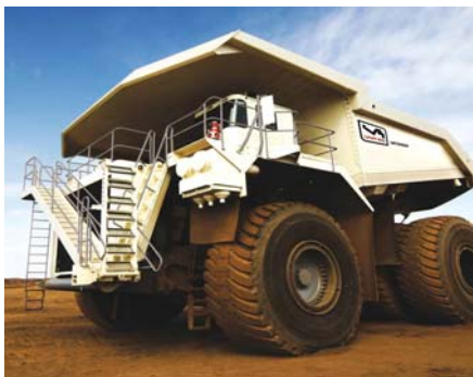
Slika 2. Unit Rig (Terrex&Co.), damper sa elektro pogonom [10]
