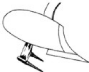
Slika 1. Plug-razrivač u obliku šiljka
