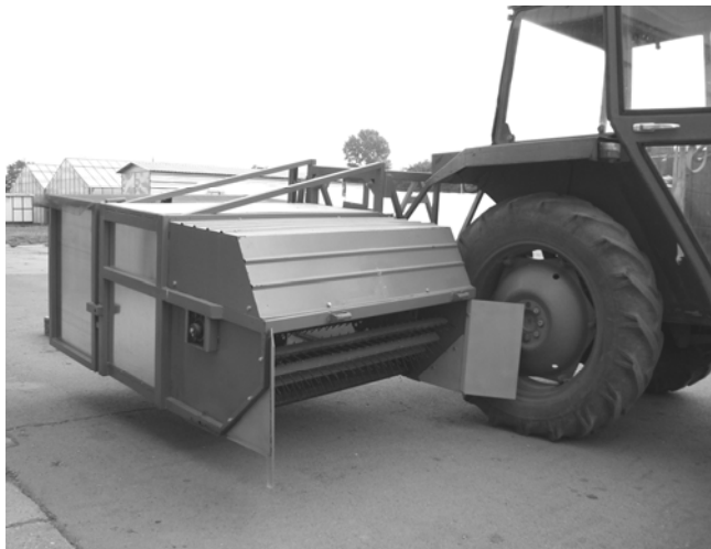
Slika 1. Traktorom nošena mašina za branje cvasti kamilice sa radnim organom tipa virtuelnog rotirajućeg češlja sa zubima širokog razmaka
